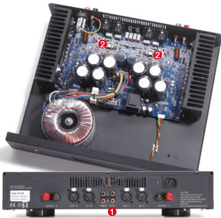
Das Anschluss-Sortiment des PI 2 umfasst auch Fixpegel-Eingänge für den Surround-Dienst (1). Sonst übernehmen Wolfson-ICs (2) mit Widerständen die Lautstärkeregelung.
